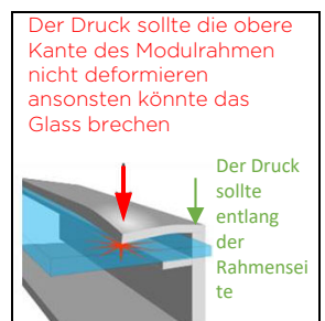
Abbildung 1a: Druck auf die Klemmenstellen
